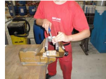
Manuelle Fertigung (Feilen)
