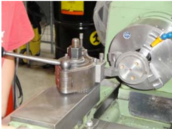
Konventionelles Fertigungsverfahren (drehen)
